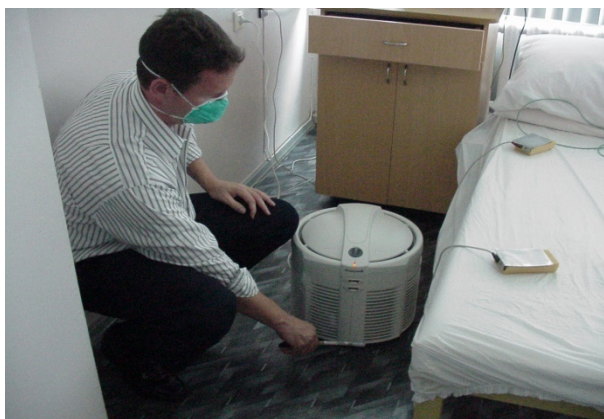
Рисунок 6.4.2. Размещение HEPA-фильтров в помещениях
