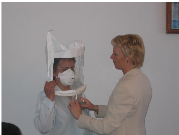
Рис. 7.3.7. Качественный тест на герметичность респиратора
